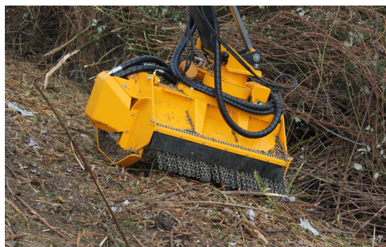
Voor de veiligheid is de bosbouwmaaier aan de achterzijde voorzien van een zwaar kettingscherm.
