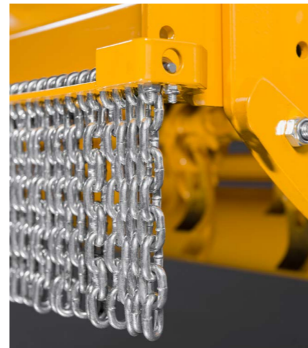
Voor de veiligheid is de mechanische maaier voorzien van een kettingscherm, voor het tegenhouden van wegschietende keien bijvoorbeeld.
