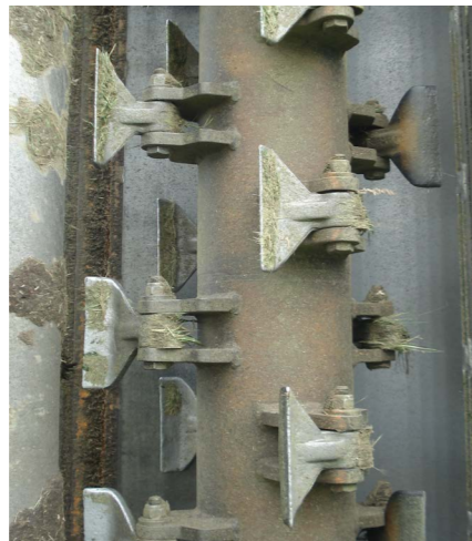
De oerdegelijke klepels van Herder zijn slijtvast en voldoen aan de hoogste eisen. U heeft de keuze uit "40 x 12 klepels" of "1,2. kg klepels"
